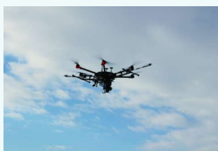
UAVによる3D測量 (レーザ計測・SfM)
